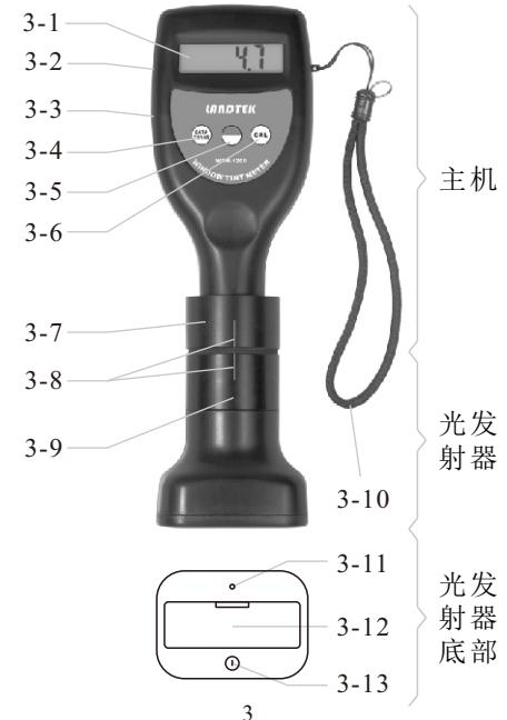
器显示为零，校零完成。校零时，探头应避免光线进入，以免造成零点误差。
